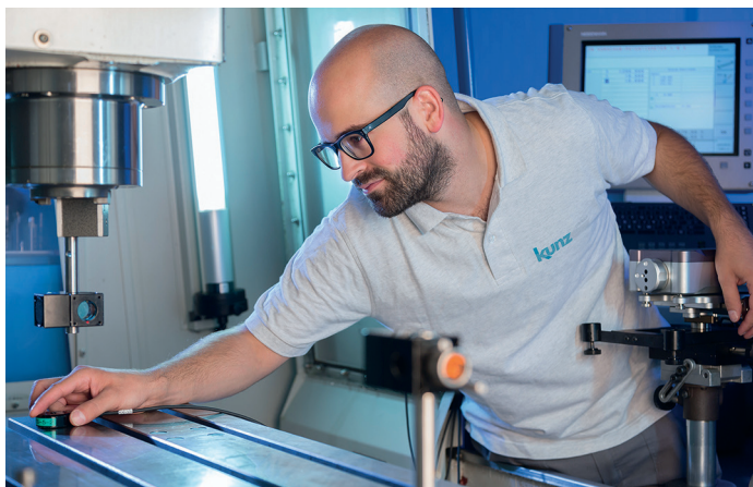
Markus Giger (Co-Leiter Mess- und Kalibrierdienst) beim Einrichten einer Laserinterferometriemessung.
