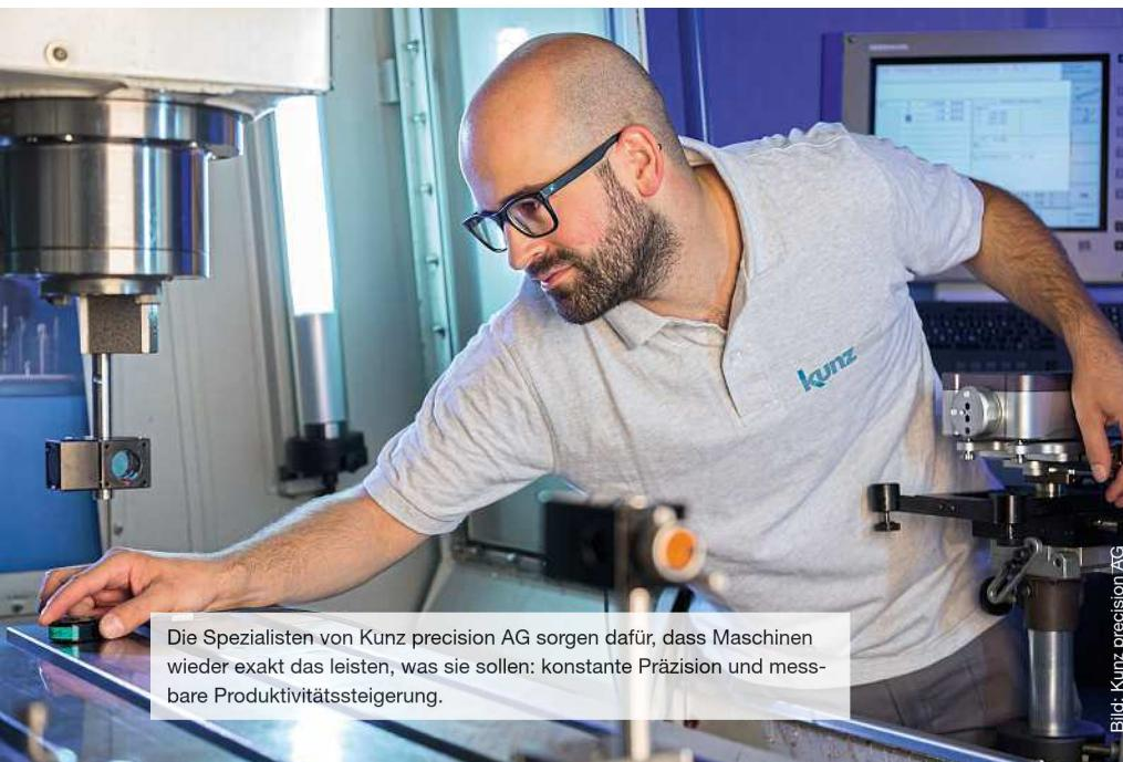
Ein zentrales Verfahren ist die Optimierung der Positioniergenauigkeit. Empfohlen bei Inbetriebnahme und in regelmässigen Abständen, hält sie Maschinen über Jahre hinweg präzise und macht Probleme frühzeitig sichtbar. Linearachsen werden mit dem Laserinterferometer und Rotationsachsen mit dem Drehwinkelmessgerät geprüft. Die festgestellten Positionsabweichungen können in der Maschinensteuerung optimiert werden.
